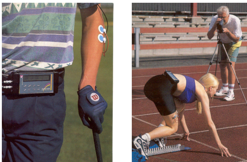
Ilustracija 4.5: Površinske elektrode elektromiografa postavljaju se iznad mišića za kojega se prikupljaju podaci.
